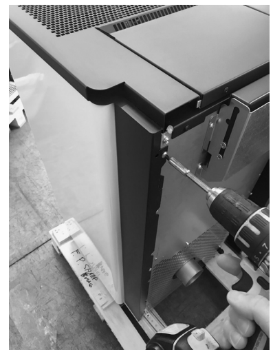
Fig. 45 - Fixer le flanc complet
