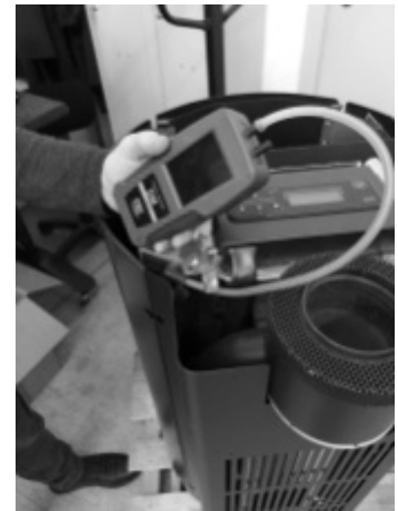
Fig. 71 - Connexion du pressostat numérique
