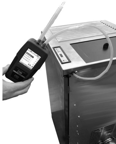
Fig. 70 - Connexion du pressostat numérique
