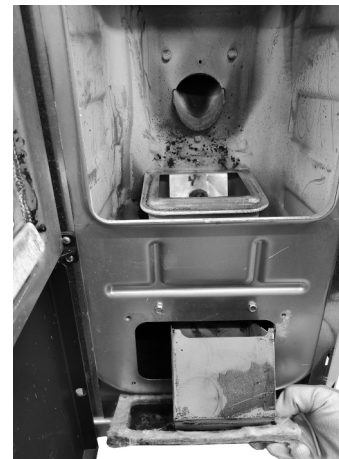
Fig. 77 - Retirer le bouchon d'inspection
