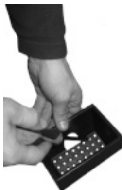
Fig. 34 - het schoonmaken van de vuurpot
