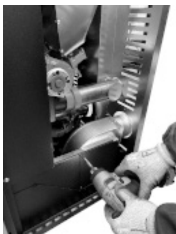
Fig. 33 - Positionering van de buizen voor kanalisering
