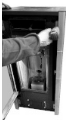
Fig. 18 - Verwijder de schroeven
