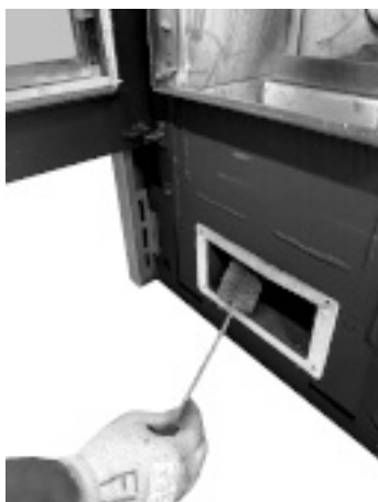
Fig. 51 - Reinig met pijpenwisser
