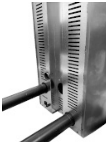
Fig. 31 - Uitlaat voor de warme lucht achteraan
