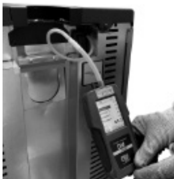
Fig. 46 - Aansluiting digitale drukregelaar (Atena 3 Plus12/14 - Duke 12/14 At - Saba 12/14)
