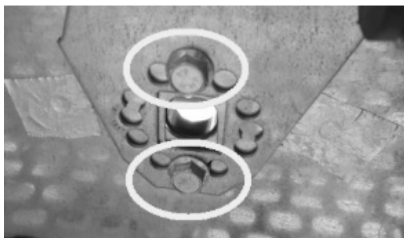
Fig. 69 - Verwijder de schroeven
