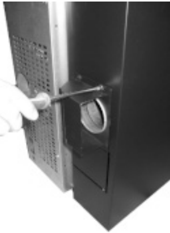
Fig. 42 - Montage van de verdeler
