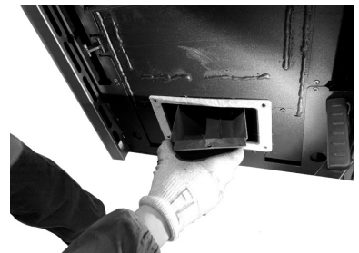
Fig. 64 - Verwijder de rookgasafleider
